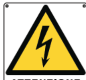
ATTENZIONE Quadro provvisto di più alimentazioni. Per lavori di manutenzione accertarsi che tutti gli interruttori automatici, facenti capo ad ogni singola alimentazione, siano disinnescati. E440702 KW
