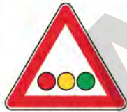
F.R 190 031 B semaforo con lanterne orizzontali
