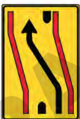
FCR 790 412 A segnalazione carreggiata chiusa
