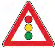
F.R 190 031 A semaforo con lanterne verticali
