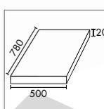
**5 PGE9025** - paracolpi piano rigato mm 780 x 500 x h 20 colore giallo/nero, spessore 20 mm, peso kg 1,9, senza biadesivo
