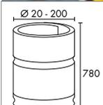
**4 PGE8015** - paracolpi cavo rigato giallo/nero, senza biadesivo. Protegge colonne tonde, pali e corrimano, utilizzato anche come salva colonne in parcheggi e garage. Ø minimo 20 mm, Ø max 200 mm. Altezza 780 mm, spessore 20 mm, peso kg 1,2
