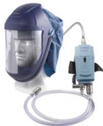
Quest'ultimo ha la funzione di depurare definitivamente l'aria da condensa ed odori prima di essere immessa nella visiera (F). Nella parte superiore del portafiltro è posizionato il regolatore di flusso (G), che assicura un flusso regolare di aria all'interno della visiera di 180 l./minuto. Il diffusore posto all'interno della visiera distribuisce uniformemente l'aria.
