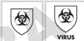
Il pittogramma riguardava, in precedenza, batteri e funghi. La nuova norma impone un nuovo test di penetrazione virale (ISO16604:2004). Se il guanto supera questo ulteriore test, viene aggiunta la parola "VIRUS" sotto il pittogramma.
